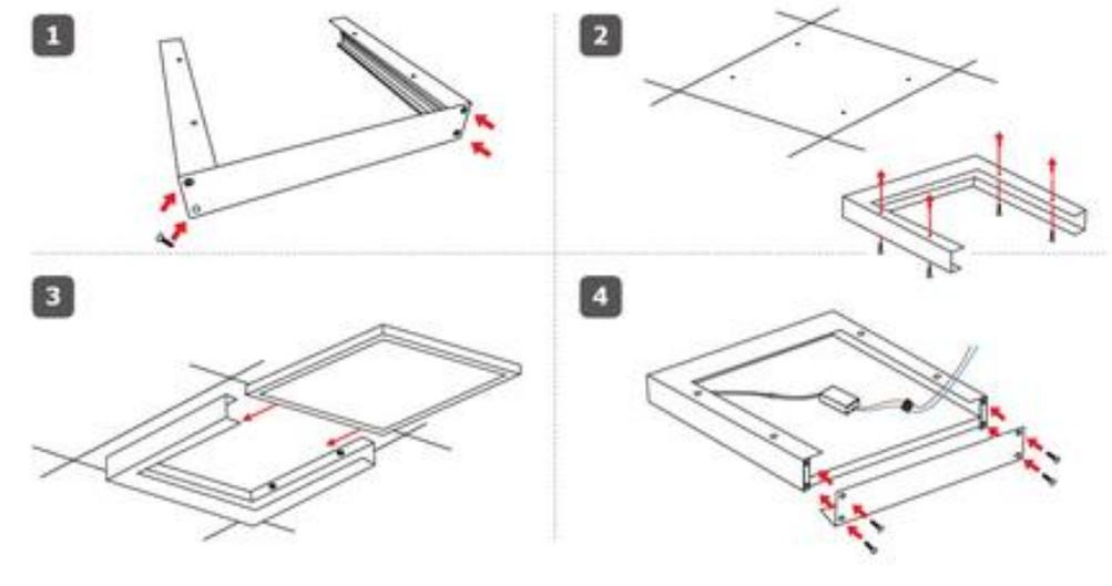
1. den Aufbau- bzw. Aufputzrahmen an vier Seiten zusammenschrauben, an die Decke halten und die Bohrlöcher mit einem Stift markieren
