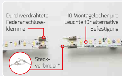
Mit Pin-Anschlüssen lassen sich die Leuchten in Reihe schalten. Verbundene Abschnitte können mit Hilfe des inklusiven Lösewerkzeugs wieder geteilt werden.
